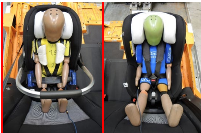
Imagen 5: Espacio escaso en la “Hauck iPro Baby” (izquierda) y en la “Hauck iPro Kids + base iPro” (derecha)
