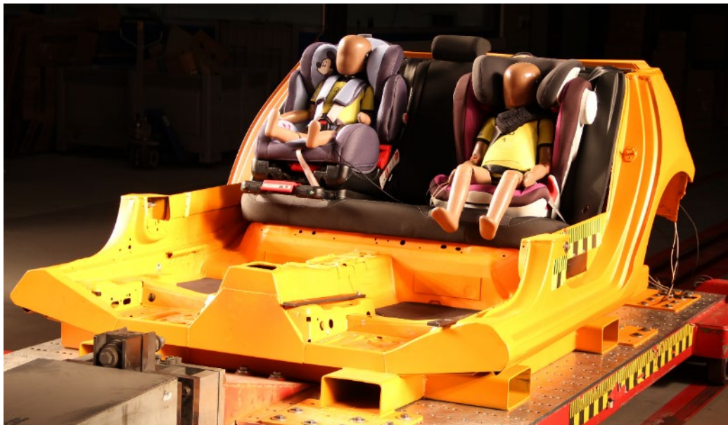
Ilustración 6: Configuración del ensayo de impacto frontal
