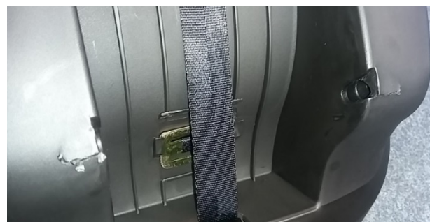
Figura 1: Puntos de rotura en Hauck iPro Baby después del ensayo de impacto
