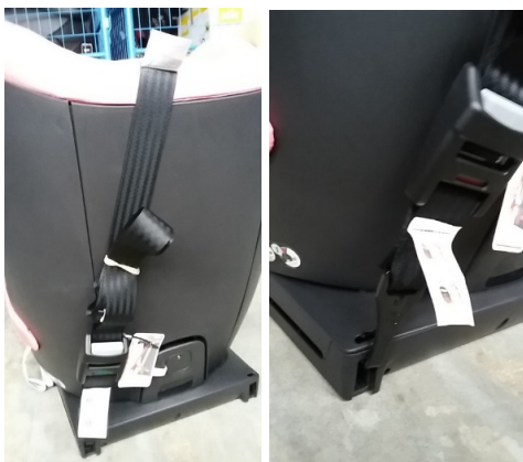
Figura 4: Dispositivo de anclaje antirrotación de “GB Everna Fix”
