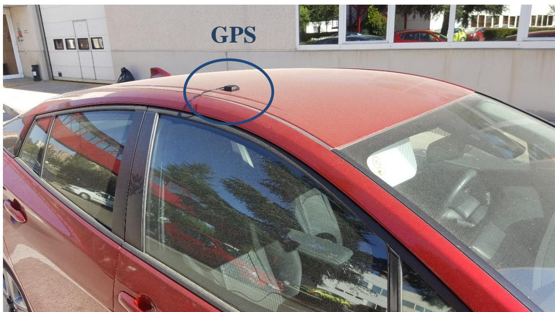
Ilustración 6: Detalle GPS
