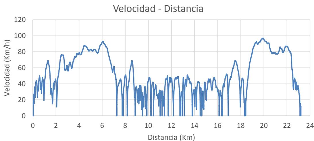
Ilustración 3: Gráfico de velocidad del vehículo en función de la distancia recorrida
